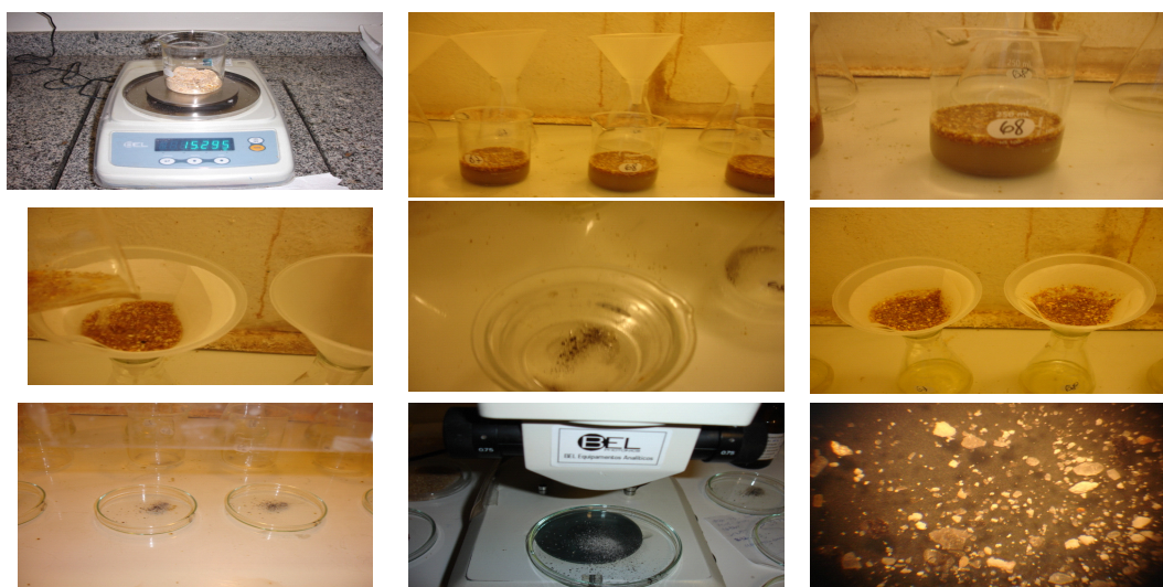
Figura 1 - Imagem apresentando amostra da ração farelada íntegra e com as frações mineral e orgânica separadas. As imagens foram obtidas utilizando microscopia óptica com 20 X de aumento.
