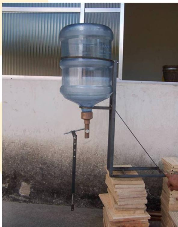
**Figura 3:** Hidrolisador de cana-de-açúcar simplificado.
