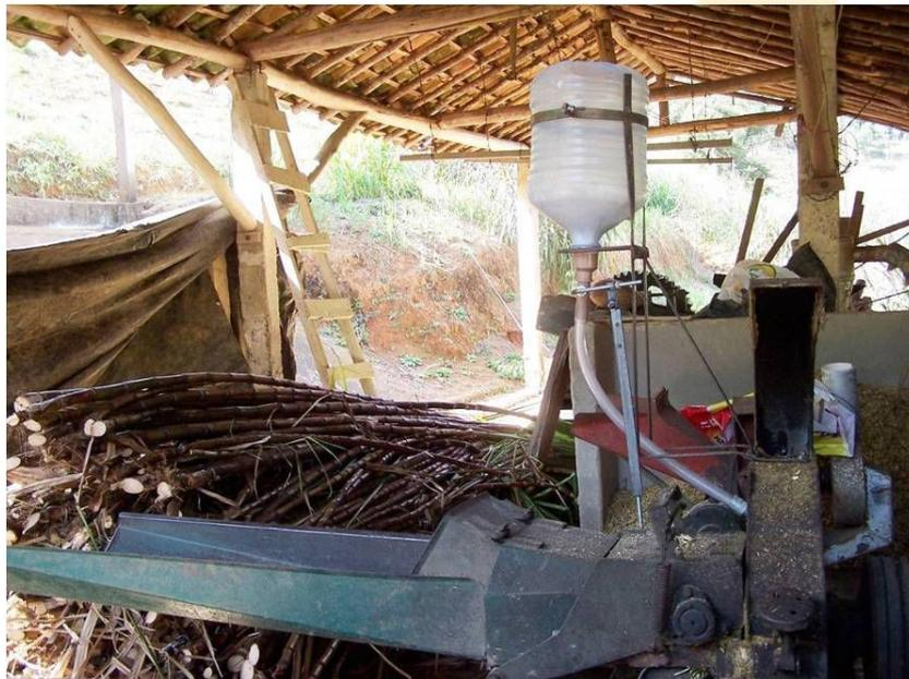
**Figura 2:** Hidrolisador de cana-de-açúcar para utilização de cal em pó.
