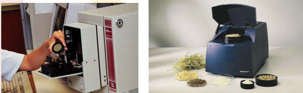
**Figura 1.** Espectroscópio de refletância no infravermelho próximo (NIRS).
